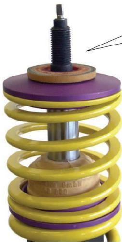
Angeliefertes Federbein mit aufgestecktem Serien Lagerdichtung.
